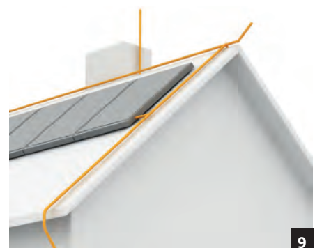
Direkter Anschluss der PV-Montagegestelle an das Blitzschutzsystem
